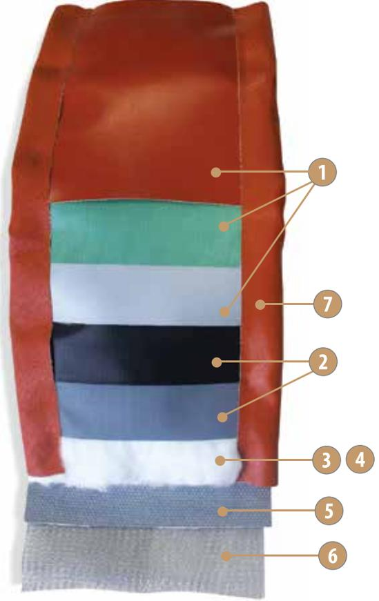
**6- Dengeleme Katmanı:** Boyutsal dengeleri sağlayan, üst katman rijidliğine destek olan, sürtünme deformasyonlarını azaltıcı, geniş gözenekli ve esnek paslanmaz çelik tel kafes katmanı
